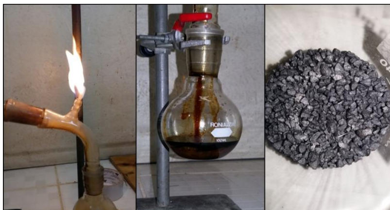
Legenda*: Da esquerda para a direita> gases não condensáveis, bio-óleo, biocarvão ou biochar . Fonte: CASTRO (2019).
