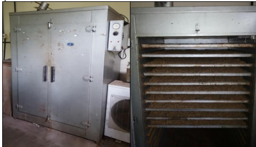
Figura 13 - Estufa com circulação de ar e controle de temperatura e a disposição do material nas bandejas do equipamento.
